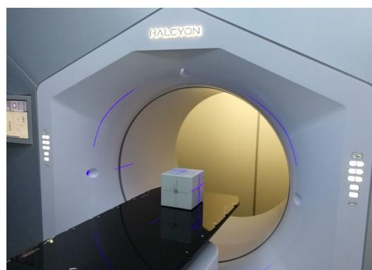
*Рис. 2.3. Проверка точности положения лазеров с применением КТ-фантома [13]*
