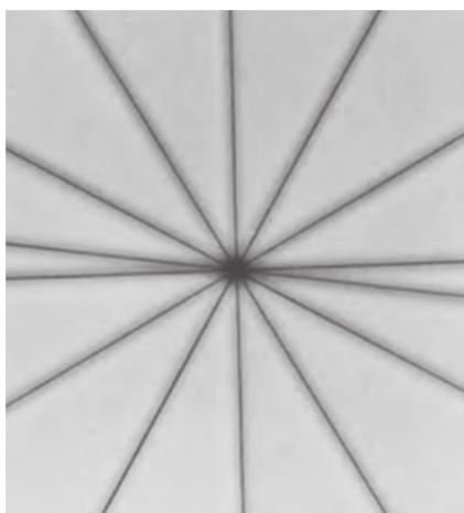
Рис. 5.4. Определение центриции МЛК методом «spoke shot»
