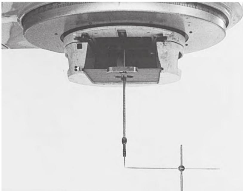
*Рис. 5.1. Определение механического изоцентра гантри при помощи двух указателей*
