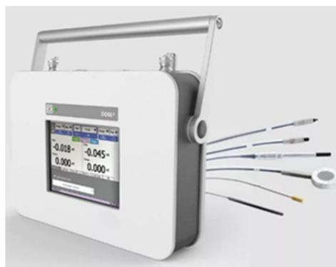
Рис. 2.1б. Ионизационная камера и электрометр [12]
